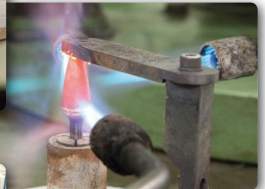
Der Lötvorgang The brazing process
